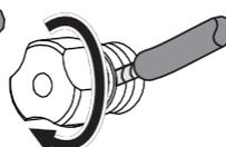
**ВАЖНО!** Убедитесь, что провода или контакты (+) и (-) не касаются друг друга или других клемм. В противном случае может произойти короткое замыкание, которое может повредить ресивер или усилитель.
