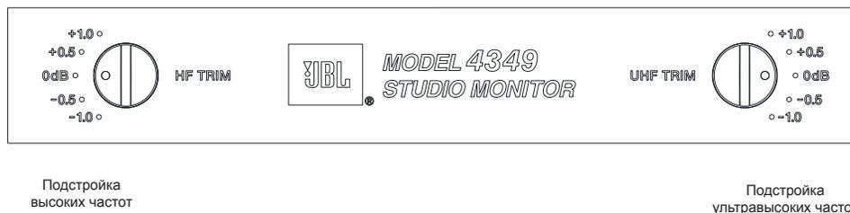
Используйте эти регуляторы для изменения звука колонки в соответствии с акустикой помещения или личными предпочтениями. Для возврата колонок к заводским настройкам установите регуляторы на «0 дБ».
